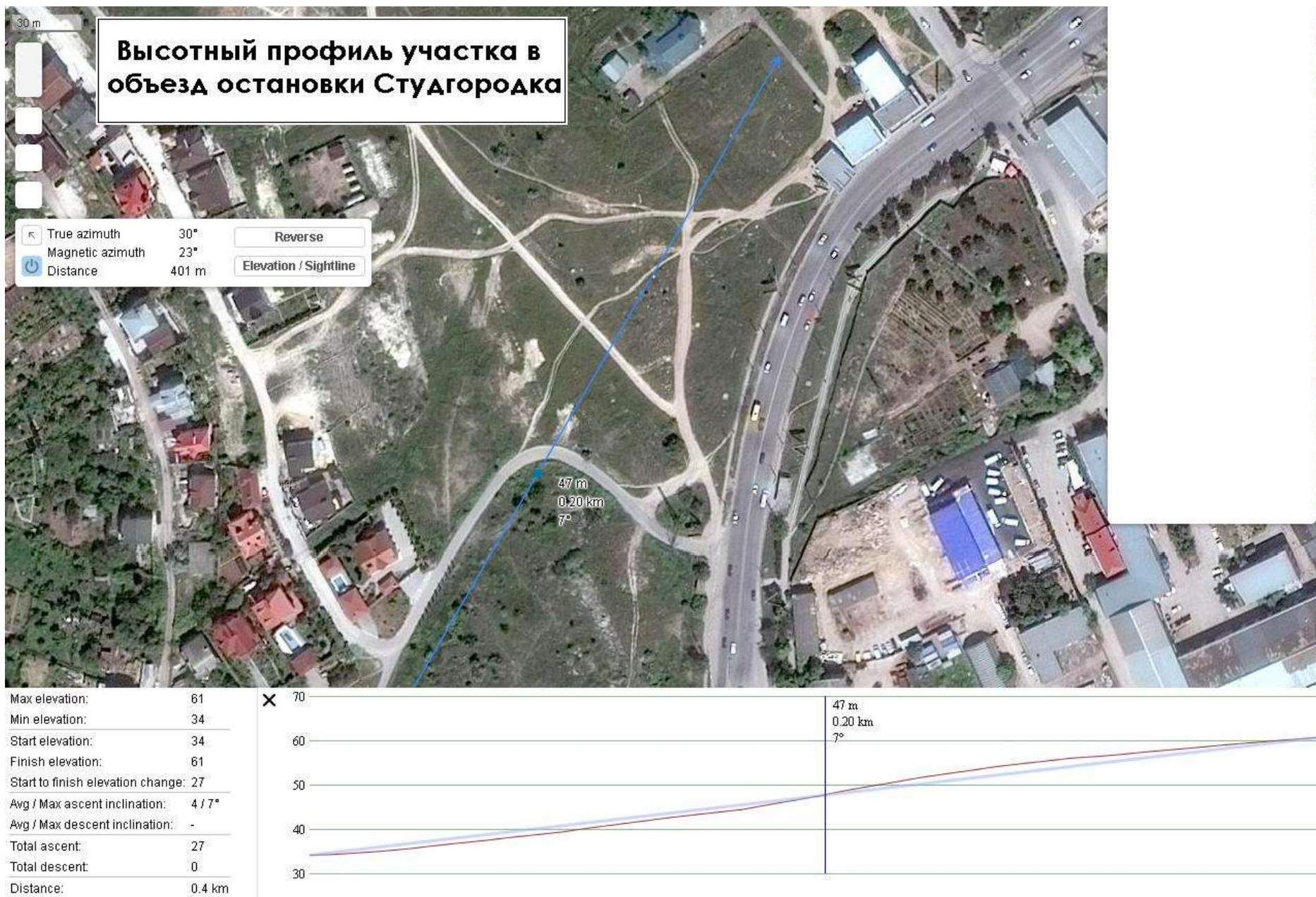
Рисунок 21 – Высотный профиль участка одностороннего движения в обход остановки Студгородка.
