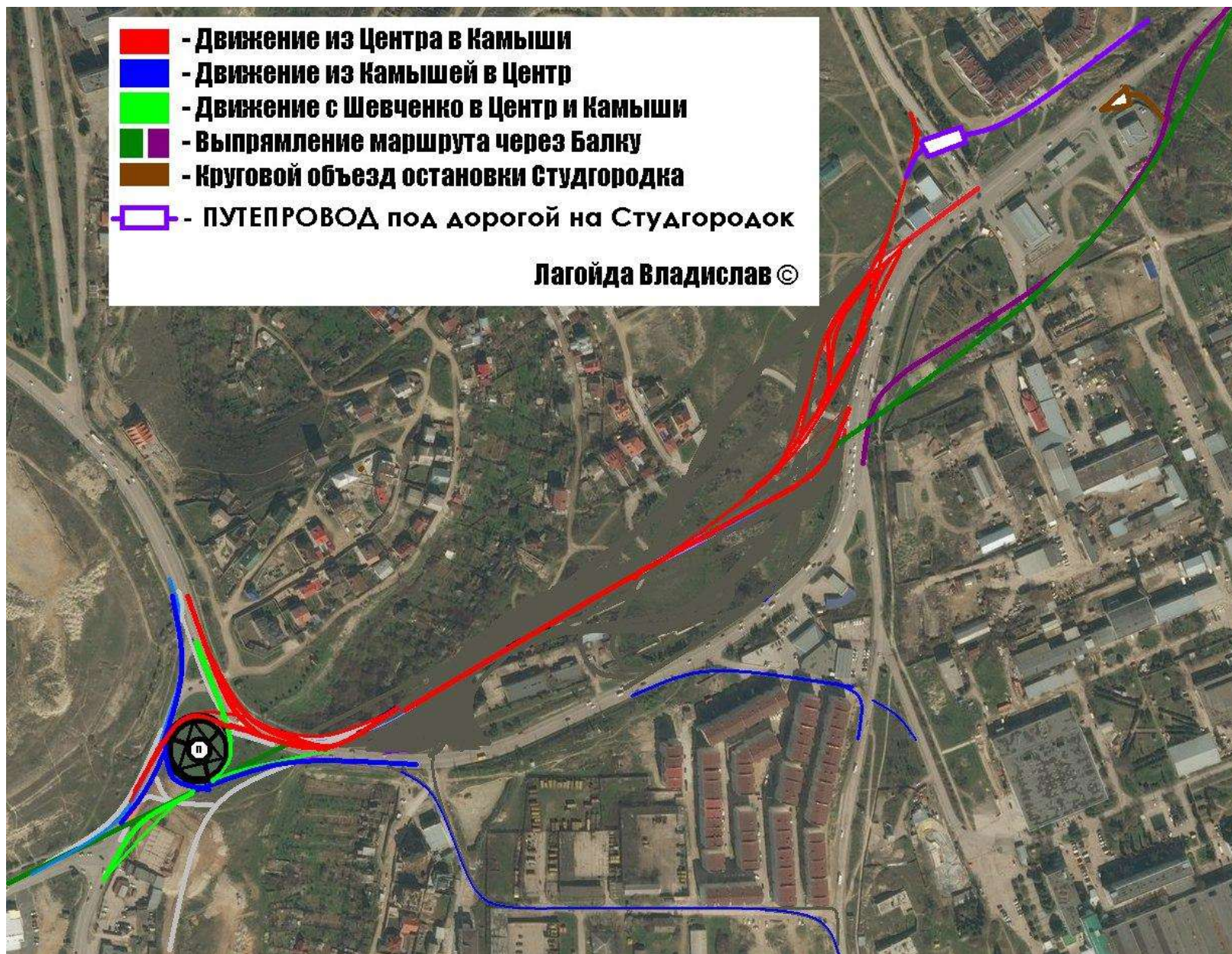
Рисунок 22 – Схема размещения путепровода.
